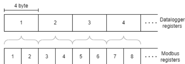
Figura 8.1: corrispondenza tra registri del datalogger e registri Modbus.
