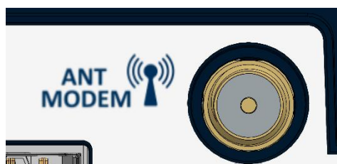
Figura 3.8: connettore RF per antenna GSM.
