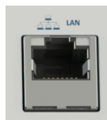
Figura 3.5: connettore Ethernet RJ45.
