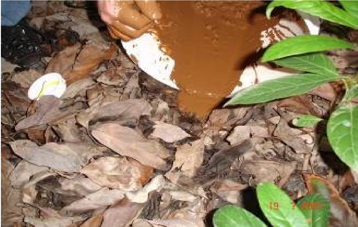
Figura 2. Preparazione della miscela – Il terreno raccolto durante la perforazione viene mescolato con acqua per formare una miscela liquida. Versare con cautela la miscela per evitare la formazione di bolle d'aria.
