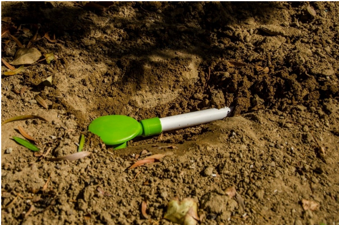
Figura 4. Nascondere il cavo della sonda – Utilizzare un condotto di plastica per nascondere e proteggere il cavo. Coprire lo scavo con la terra smossa e compattare leggermente.
