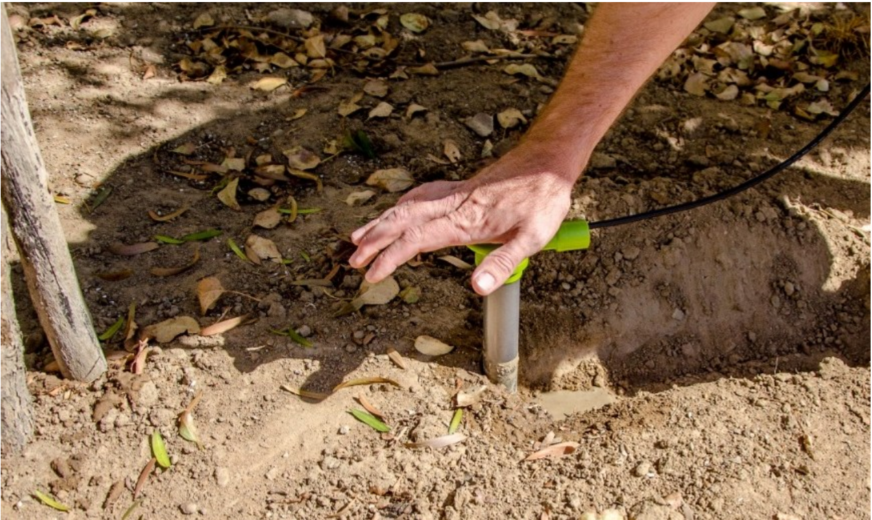
Figura 3. Installazione della sonda – Premere delicatamente sulla sonda fino a raggiungere la profondità desiderata. Rimuovere eventuali residui della miscela.
