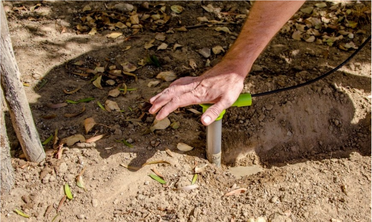
Figura 3. Instalación de la sonda: presione suavemente la sonda hasta alcanzar la profundidad deseada. Retire cualquier residuo de la mezcla.
